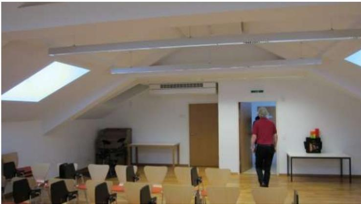
Abbildung 2: Dachgiebel weit über dem Zuluftauslass und abgependelte Beleuchtungsschienen quer zur Strömungsrichtung. Die Strömung kann sich so nicht an der Decke anlegen und führt zu Zugerscheinungen im Bereich der Sitzreihen.
