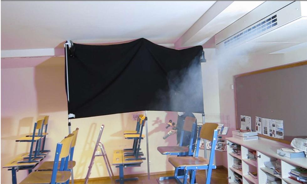
Abbildung 4: Strömungsvisualisierung durch Nebel in Zuluft zeigt abfallende Luft im Bereich der hinteren Sitzreihen (Grund: Strömungsablösung durch zu großen Deckenabstand und Versatz)
